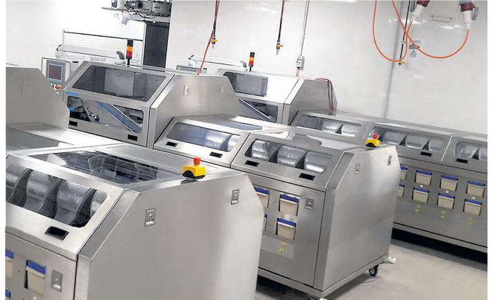
Via Video-Erkennung ist es möglich, den Bestecktyp zu erkennen: Die Bestecksortieranlage Brimato ABS Typ II sortiert so bis zu 99 Bestecksätze sortenrein in Besteckkästen. Grafik und Foto: Brimato
